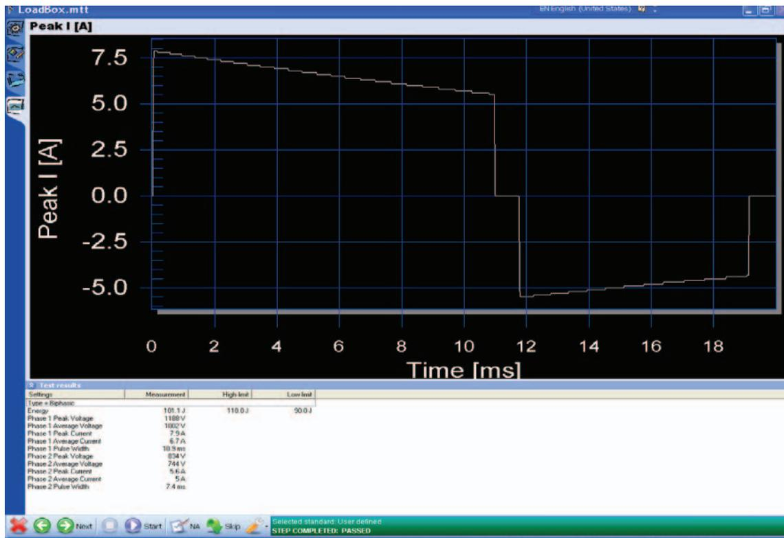
Figura 2: curva de descarga del desfibrilador durante la prueba de medición de la energía (carga externa de 150 ohmios y nivel de energía predeterminado de 100 julios)
